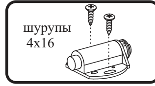
схема монтажа толкателя
