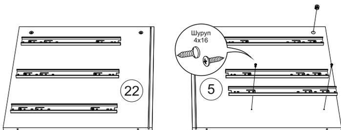
**2)** Закрепить направляющие к боковинам 5 и 22 шурупами 4x16. Закрепить опоры к крышке 9 шурупами 4x30.
