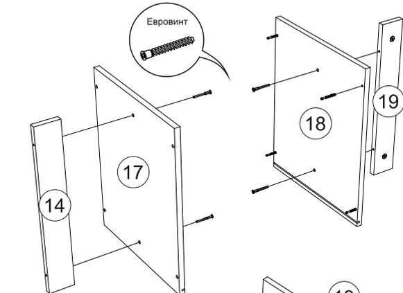
**12)** Закрепить перегородки 14 и 19 к крышкам 17 и 18 евровинтами, как показано в инструкции.
