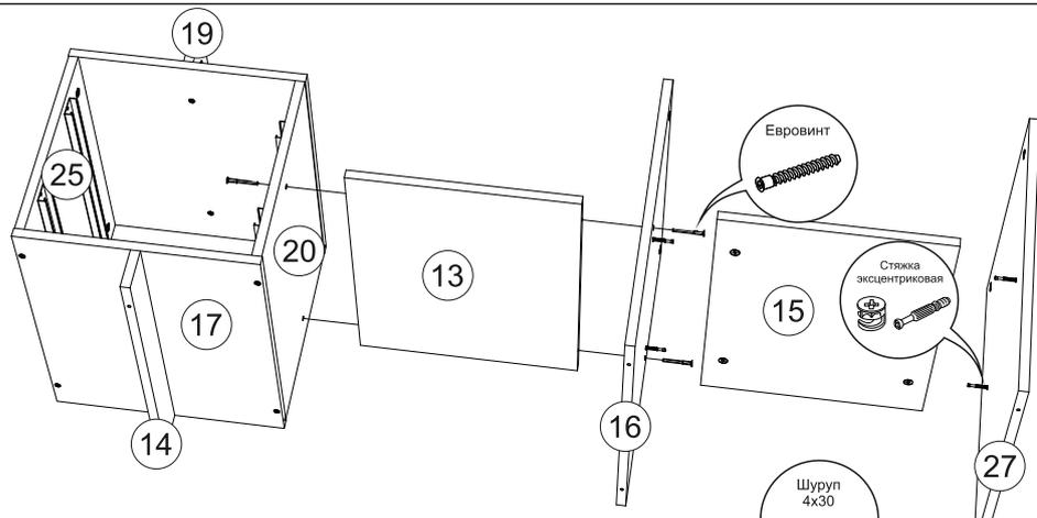
**15)** Соединить вязку 13 с боковиной 20 и перегородкой 16 евровинтами. Закрепить вязку 15 к перегородке 16 и к боковине 27 эксцентриковыми стяжками.
