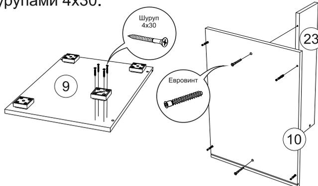
**3)** Установить штоки эксцентриковых стяжек на крышку 10. Соединить крышку 10 с перегородкой 23, используя евровинты.
