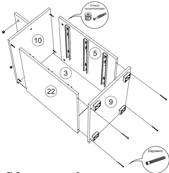
**5)** Заднюю стенку 3 зафиксировать к боковинам и крышкам уголками Rv8 при помощи шурупов 4x16, предварительно выровняв диагональ при помощи рулетки.
