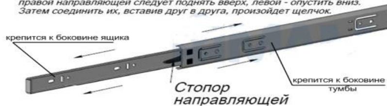
Рис.2 Схема установки шариковых направляющих
