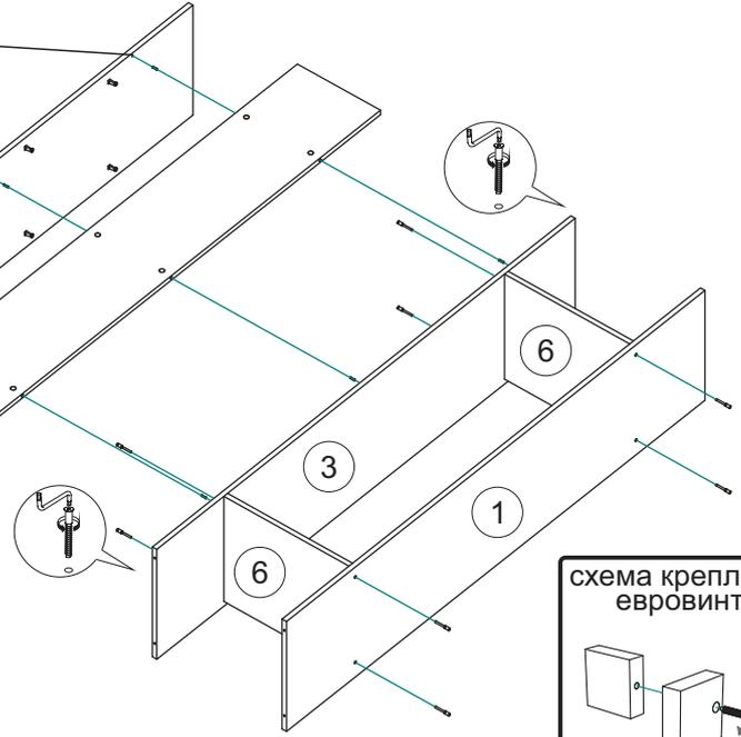
3. Затем с помощью евровинтов соедините боковины №1, №2, перегородку №3 и заднюю стенку №4 с крышками №5.
