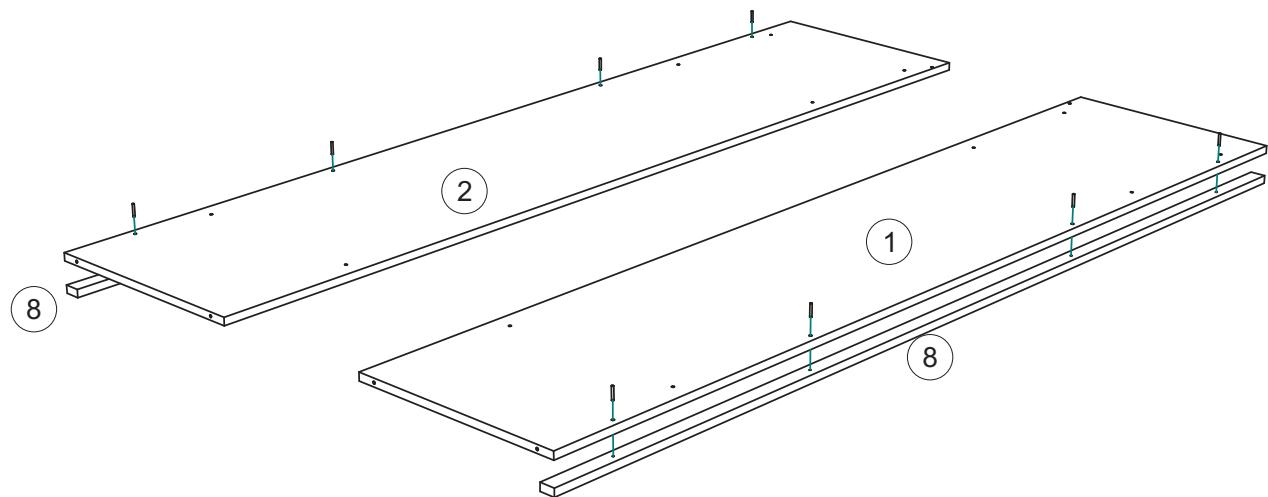
3. Используя эксцентриковые стяжки соедините вязки №3 и цоколь №5 с боковинами №1, №2. Затем с помощью евровинтов соедините крышку №4 с боковинами №1, №2.
